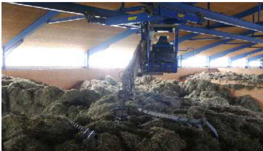
Espace séchoir fourrage avec griffe de manutention. GAEC Mielink, commune de Croisilles, Calvados.
